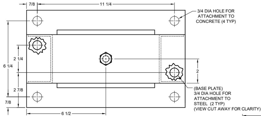
MODEL M2SS-2D SEISMICALLY RESTRAINED VIBRATION ISOLATOR FOR 2" DEFLECTION
